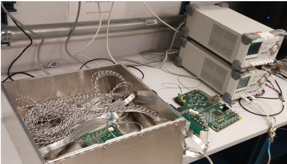
WIB + FEMB + 7m miniSAS cable + 7m power cables
