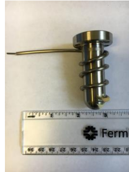
New Cesium boiler
