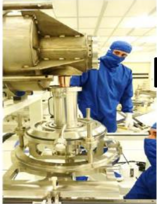
ASSEMBLAGE DU TRAIN DE CAVITÉS EN SALLE BLANCHE ISO 4
