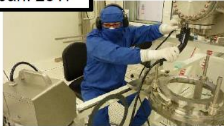
ASSEMBLAGE DU TRAIN DE CAVITÉS EN SALLE BLANCHE ISO 4
