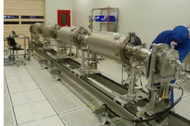
ASSEMBLAGE DU TRAIN DE CAVITÉS EN SALLE BLANCHE ISO 4
