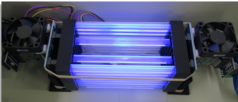
LLNL ^6\text{Li} -doped PSD scintillator rods 11cm X 0.5cm X 0.5cm
