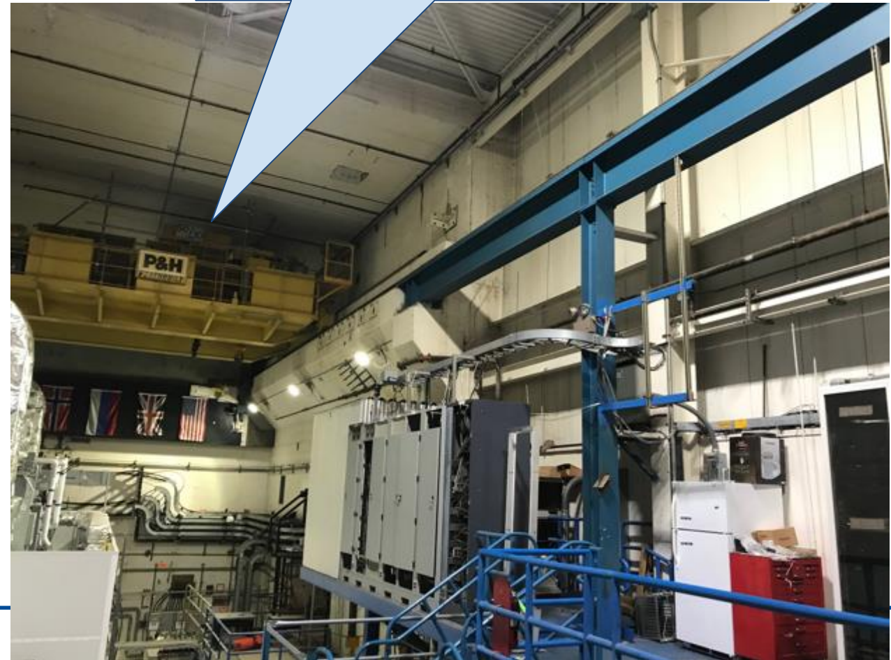
50 Ton and 10 Ton crane, 10.16 m hook height
