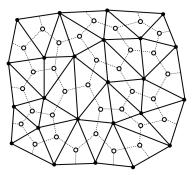
$$S_{\text{tri}} = -\sum_{\langle ij \rangle} K_{ij} \sigma_i \sigma_j \qquad S_{\text{dual}} = -\sum_{\langle ij \rangle} L_{ij} \sigma_i \sigma_j$$
