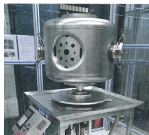
HPR: 100bar, 30mm/min., 10L/min.
