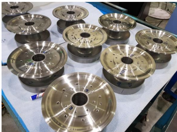
Brazing (Beam & RF Port)
