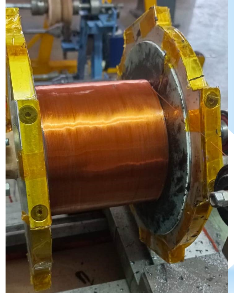
MC2 last layer with STYCAST
