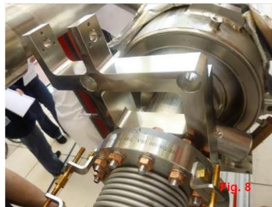
6. Positionner en équilibre le châssis tuner Repaire 1 autour de l'axe de la cavité (Fig. 8)
