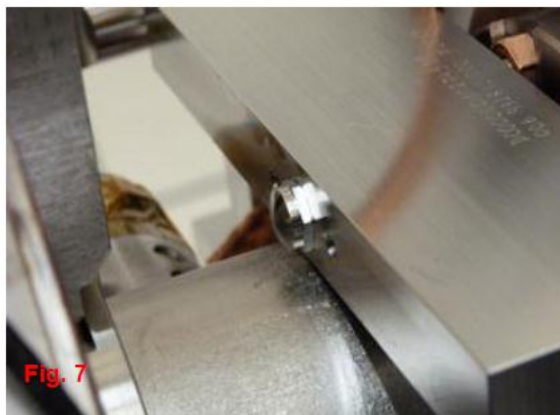
5. Monter sur le châssis tuner, les vis de réglage tuner Repaire 15 (Fig. 7)
